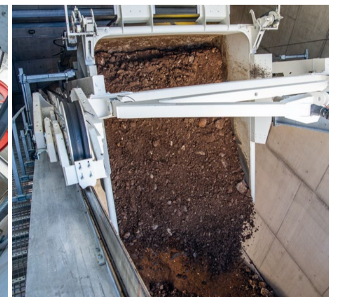
Automatische Entleerung von Aushubmaterial im Tal.
