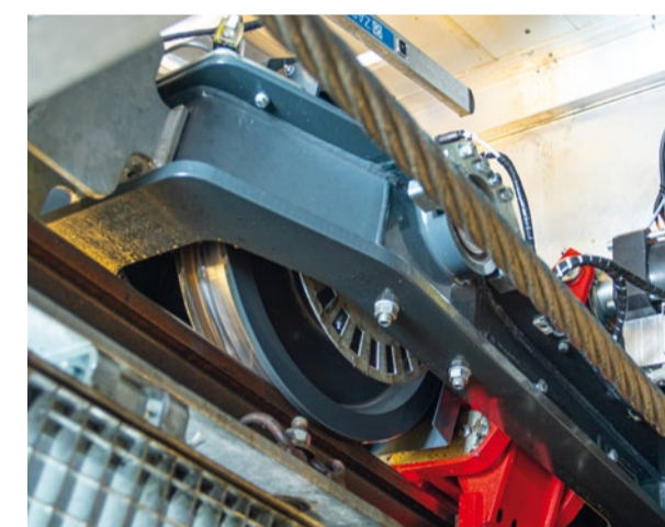
Durch eine Luffederung von den Wagen entkoppelte Fahrwerke sind eine Neuentwicklung von Steurer.
