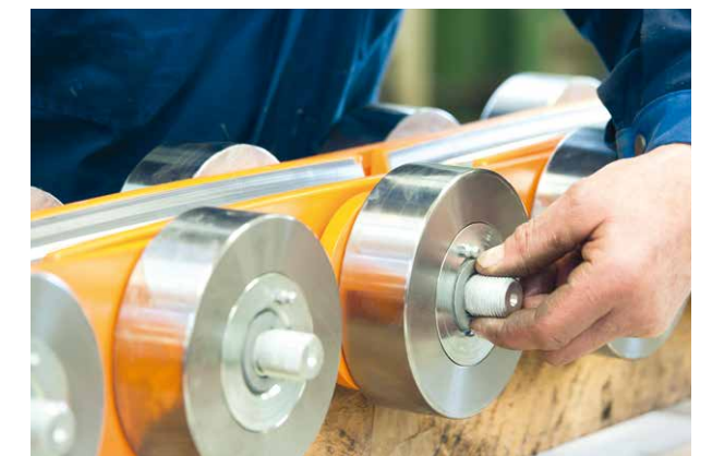
Im Werk Doren wird eine neue Rollenkette für die Tragseilabspannung der Seilbahn Dachstein-Südwand zusammengebaut.
