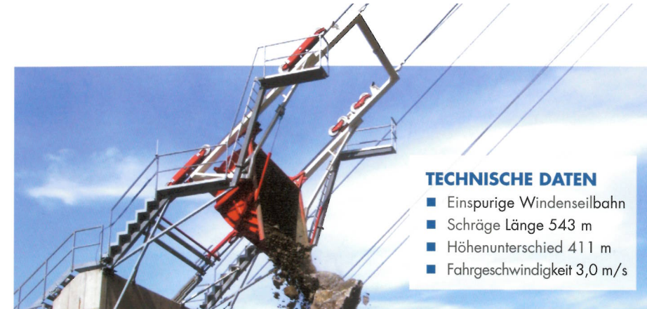
Materialseilbahn mit 18 Tonnen Nutzlast
